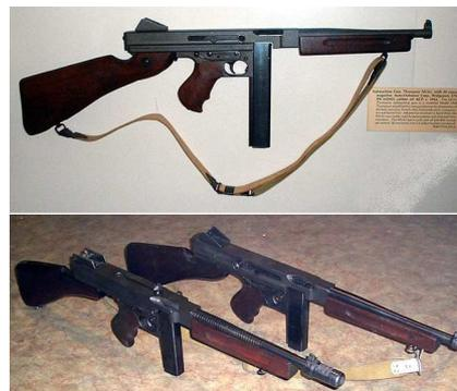
A ce propos, le premier modèle de 1921 fut suivi, à partir de 1926, du modèle « M1921AC » équipé d'un frein de bouche dit, « Cutts Compensator ». Fonctionnant par recul retardé, ses pièces sont usinées, elle est dotée d'une crosse d'épaule amovible et d'une seconde poignée pistolet placée sous la garde
