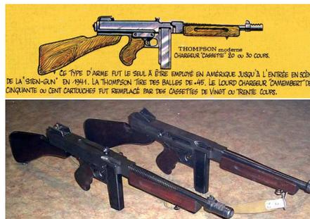
Photo du bas : on voit nettement les différences entre le Modèle 1928 A1 (en haut) et le 1928 M1, commande de 1939 avec le cuts compensator (en bas)...
